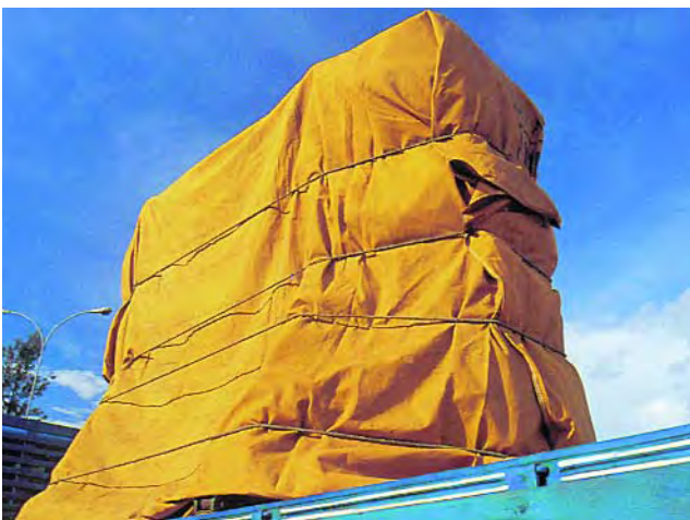
Enlonamiento para proteger el transporte del espejo
